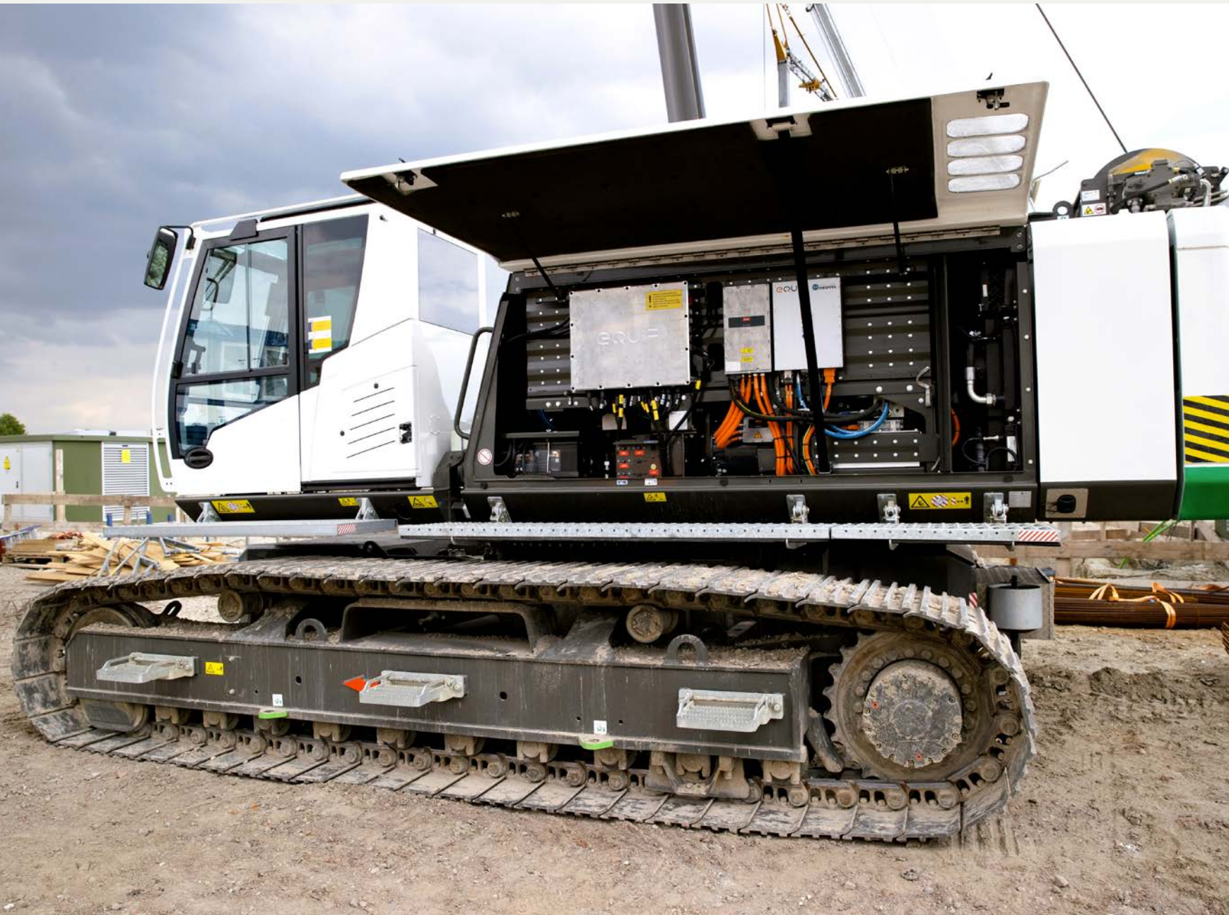
Samen met eQuip bouwt Van den Heuvel een elektrische Sennebogen 653 met 210 kWh accupakket.
