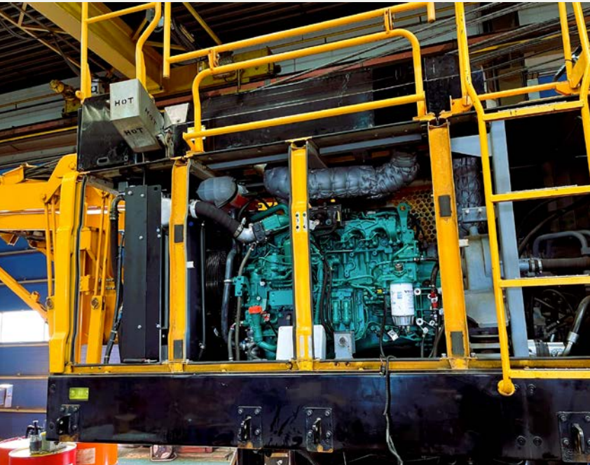
Beens Groep wil graag verduurzamen en dus is een oudere machine uitgerust met een moderne Stage V dieselmotor van Volvo Penta.
