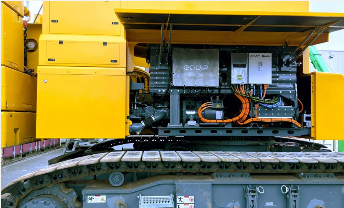
De elektrische Liebherr LTR1100 van Gebri heeft een 124 kW elektromotor en 280 kWh accupakket.
