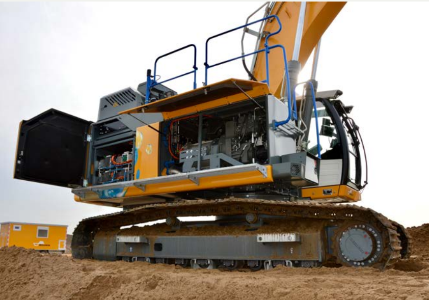
De keuze voor Toyota's TFCM brandstofcel zorgt voor een volledig geïntegreerd, compact systeem: veel vermogen, betrouwbaar en efficiënt.
