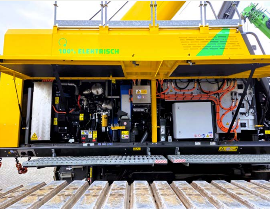
De Sennebogen 6113 – bijnaam: The Beast – van Cordeel draait full electric, maar heeft een diesel als noodaggregaat voor de hydrauliek of om de accu's bij te laden.
