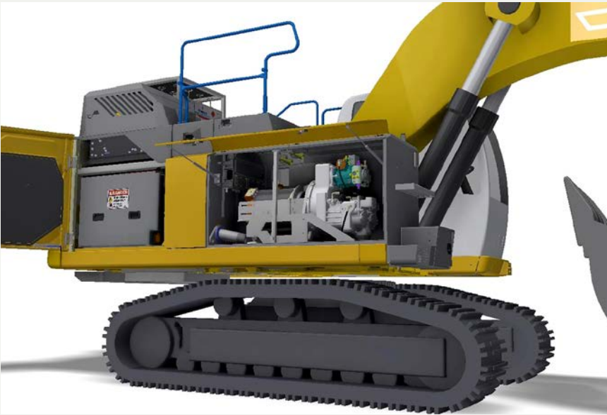
Na de primeur eind 2021 bouwen Accenda en Mourik Techniek nu een tweede Liebherr R926 om tot waterstofkraan, dit keer met verlengde giek.
