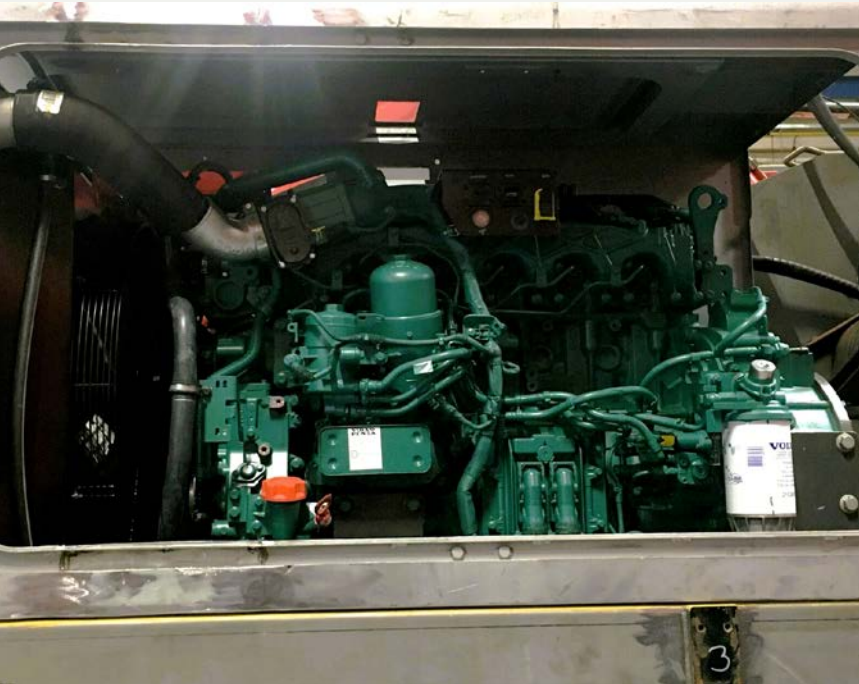
Als onderdeel van een grote revisie van de Hitachi CX900-GLS kiest Vroom voor hermotorisering naar Stage V.
