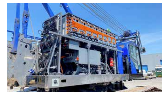
eEquip, sterk in het elektrificeren van zware bouwmachines, stond in voor het ontwerp en de realisatie van het elektrisch aandrijfsysteem van de 100-tons rupskraan van Gebr. De Koning.
